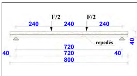
3. ábra. Az egyik oldalán berepedt fa próbatetek vizsgálata során alkalmazott statikai modell
