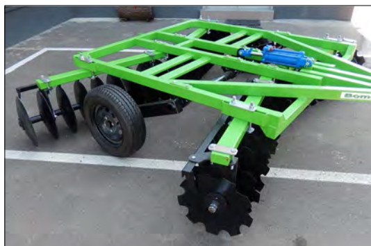
1. ábra. Bomet BTP 4×6 tárcsás borona felépítése
