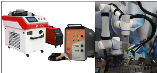
3. ábra. Kézi lézerforrások (bal) és azok integrált rendszere kobottal (jobb) [6]
