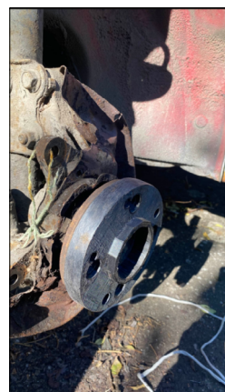
3. ábra. 3D-nyomtatott minta-osztókörmódosító
