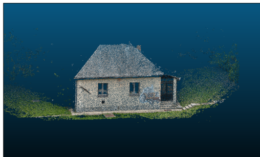
4. ábra. A sztereo-fotogrammetriai kiértékelés végtermékeként előállított pontfelhőállomány (019-es felmérés esetén)
