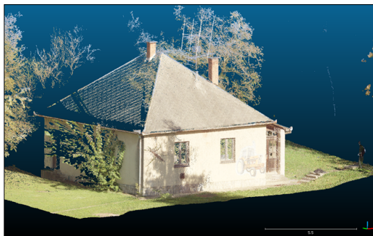
1. ábra. A felmért épülethomlokzat lézerszkennelt állománya
