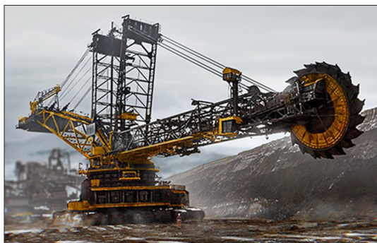
1. ábra. Marótárcsás kotrógép
