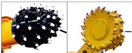
5. ábra. Különböző alkutú, forgó marófejegység-típusok
