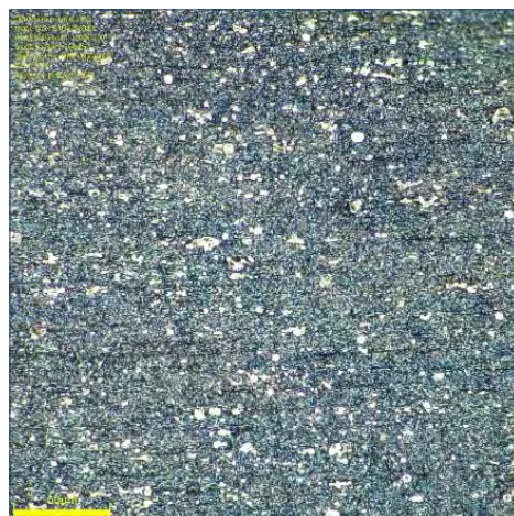
6. ábra. 4. minta, 200 °C, 5 órás hőkezelés
