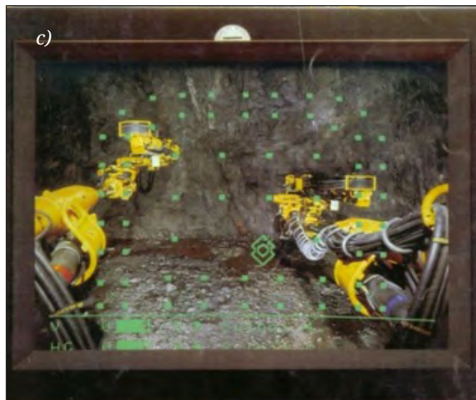
6. ábra. Az előírt fúrási séma (a), a kar a vezető sín-nel (b), megjelenítő képernyő (c)
