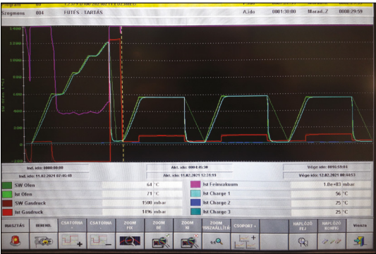
2.b. ábra. S600-as acél hőkezelési diagramja
