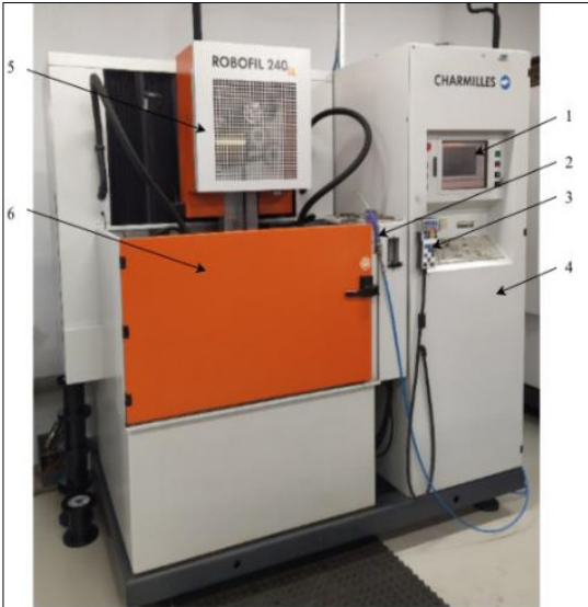
3. ábra. Charmilles FI240 típusú szikraforgácsoló gép 1. kezelő és megfigyelő terület, 2. levegőfűvóka, 3. huzalfej-tájoló egység, 4. generátortér, 5. huzladagoló berendezés, 6. munkatér
