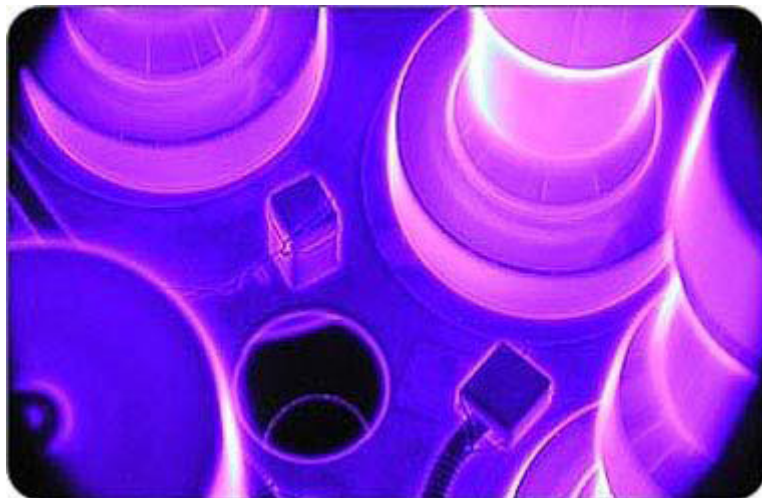
4.24. ábra. Munkadarabok plazmanitridálás közben. (Forrás: http://www.innopress.hu/index.php/technologiak/8-technologiak/18-plazmanitridalas )
