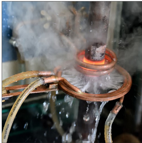
4.20. ábra. Folyamatos indukciós edzés (Forrás: https://esztergakeskft.hu/hokezeles-2/ )
