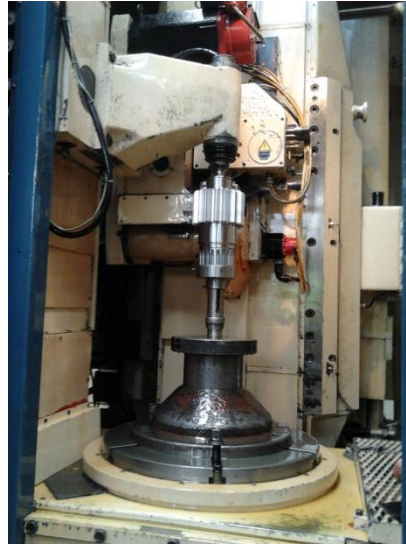
2. ábra. A CNC fogköszörűgép munkaterülete
