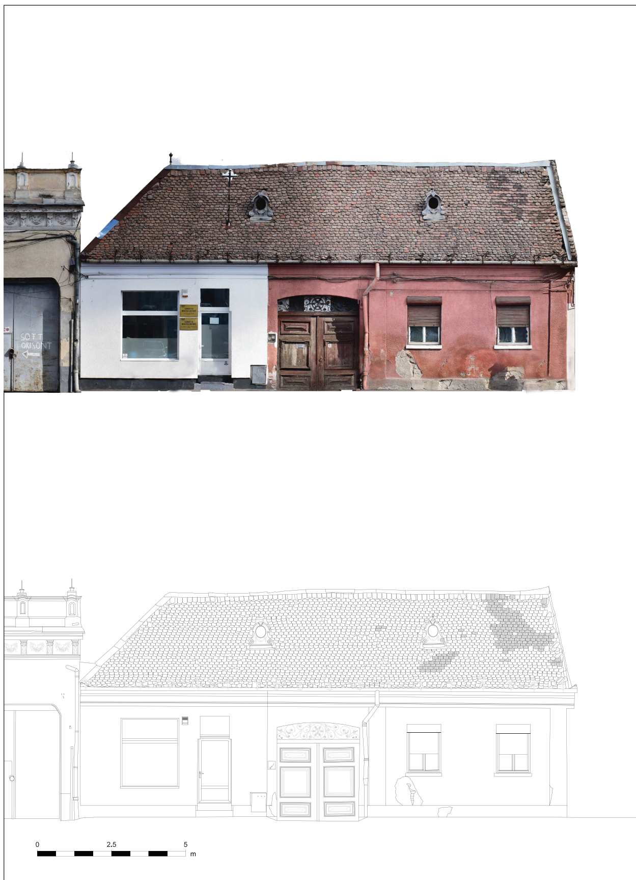
1. tábla. Călărașilor (Kossuth Lajos) utca 54. Pl. 1. Călărașilor (Kossuth Lajos) Street nr. 54.
