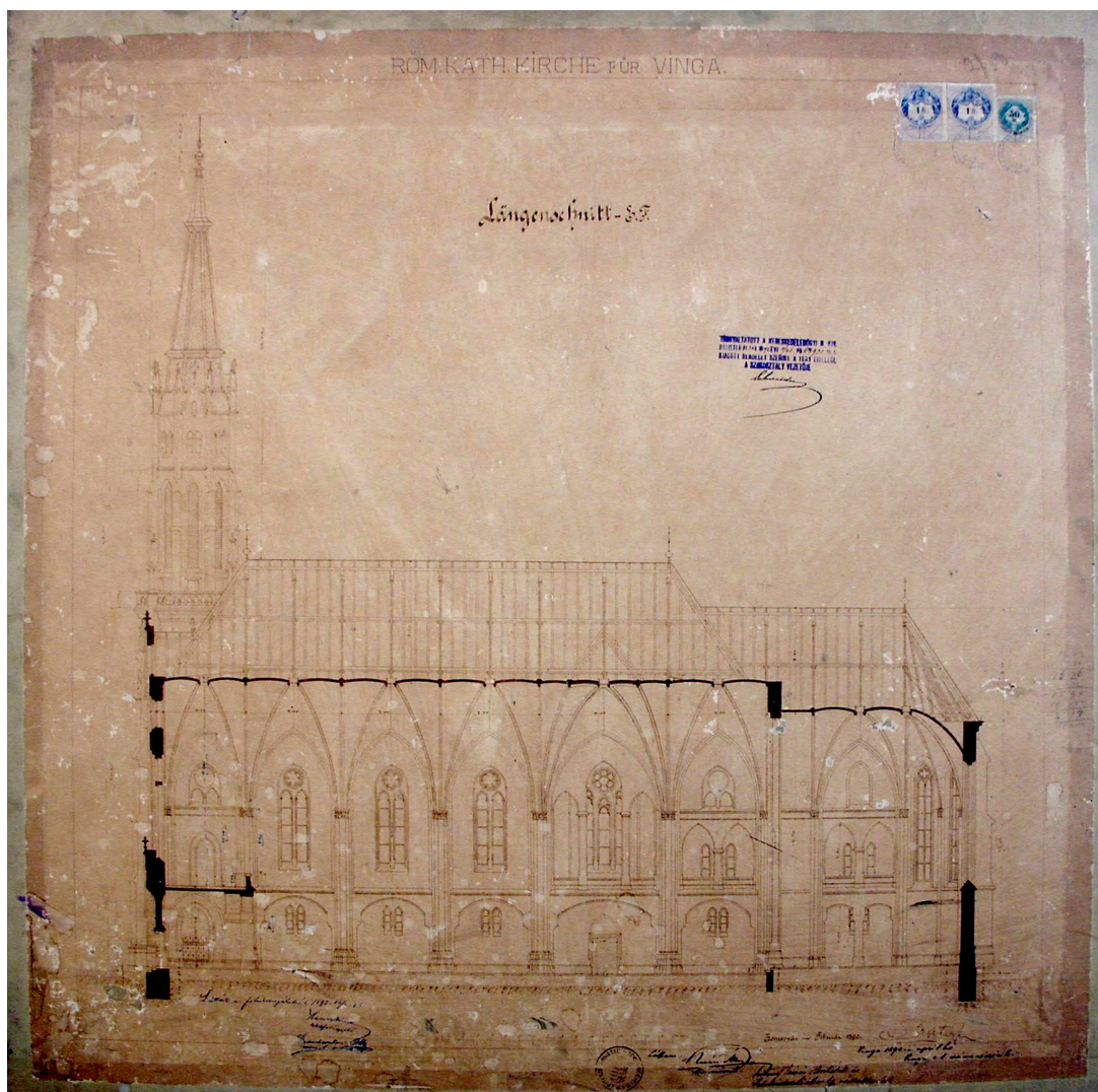
10. kép. Reiter Ede: Längenschnitt [hosszmetszet], engedélyezési terv. Temesvár, 1890. február, 1:100. Az eredeti lappang. Amatőr felvétel (2003) a Temesvári R. K. Egyházmegyei Levéltár jóvoltából. Digitális szerkesztés: Székely Márton Fig. 10. Reiter, Ede: Längenschnitt [longitudinal section], planning application. Timișoara, 1890 February. Scale 1:100. Original is missing. Amateur photograph (2003), provided by the Arhiva Diecezană Romano-Catolică Timișoara (Archivum Dioecesanum Timisoarense). Digital editing: Márton Székely, 2017
