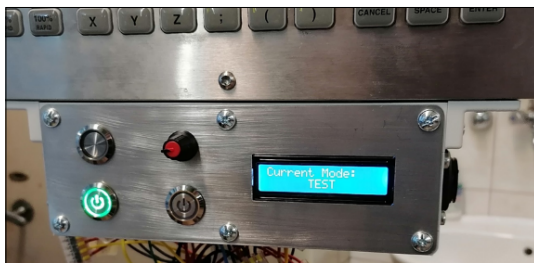
11. ábra. Lézerfejvezérlő elektronikák burkolata
