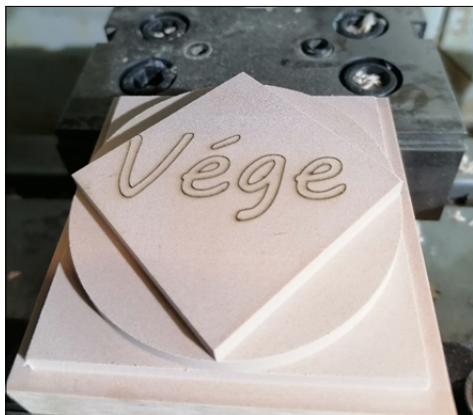
12. ábra. Tesztprogram által készített lézergravírozás
