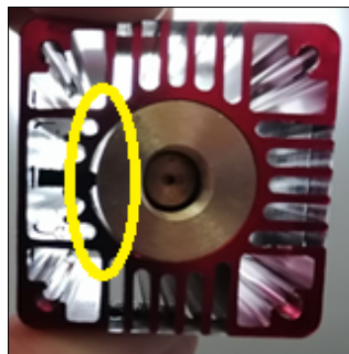
4. ábra. Lézermódul gyári hűtőrendszerének hibája
