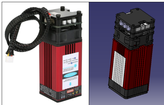
1. ábra. LD4070HF Pro gravírozófej valós és virtuális ábrája
