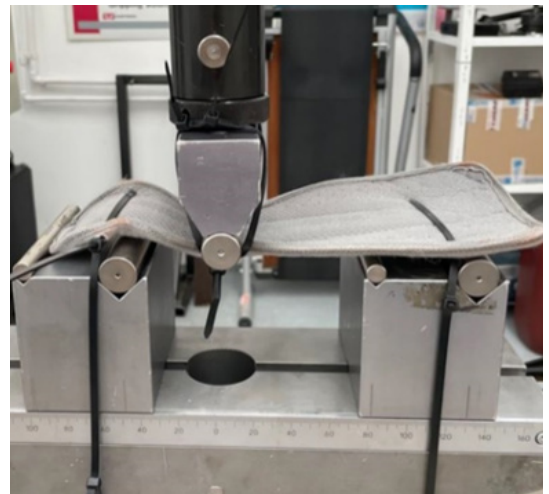
4. ábra. Az ortézis a fásztóvizsgálathoz kialakított készülékben
