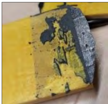
2. ábra. A részlegesen felvált ragasztott kötés a homokszórt profilon Sikapower ragasztóval
