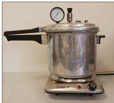
4. ábra. A minták gőzöléséhez használt edény
