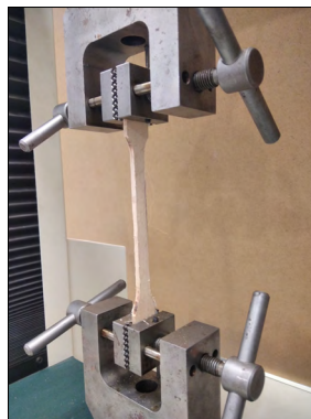
10. ábra. Húzó minta befogatása az anyagvizsgáló gépbe
