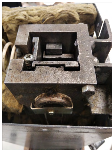
6. ábra. A tömörítőegység belső felépítése
