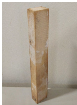
7. ábra. 20×30×200 mm méretű bükk mintatest
