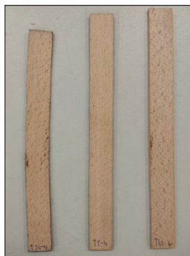
8. ábra. Hosszan fixált, röviden fixált, kezeletlen bükk mintákból kialakított félkész húzóvizsgálati mintatestek
