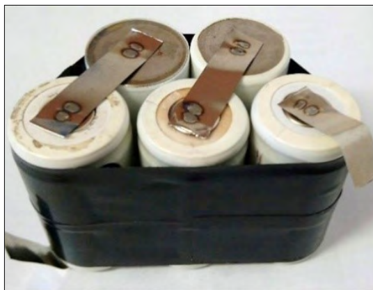
6. ábra. Az elkészített ponthegeztő berendezéssel létrehozott Ni-Cd akkupakk
