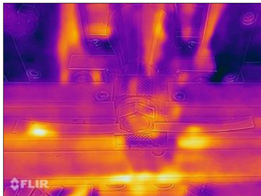
6. ábra. Ultrahangos ponthegeztés hőkamerás képe, hőmérsékleti színskálát nem tartalmaz, mert a hőkamera nem kalibrált
