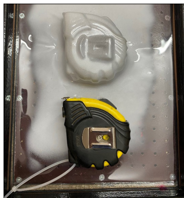
8. ábra. A tervezett vákuumformázó géppel gyártott darab
