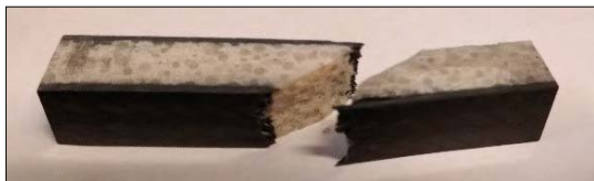
10. ábra. A szénszál szövetes kompozittal laminált próbatest a vizsgálat után
