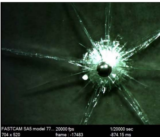
5. ábra. Ca-Na síküveg dinamikus terhelés hatására létrejött tönkremenetele
