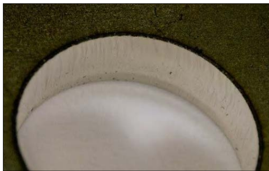
4. ábra. Koronglézerral készült furat (φ 13,6 furat)
