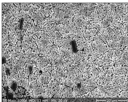
4. ábra. A megeresztési hőmérséklet hatása a szövetszerkezetre. SEM-felvételek. Marószersz: nitál. a) T_{meger} = 200\text{ °C} , b) T_{meger} = 520\text{ °C} , c) T_{meger} = 520\text{ °C} + 540\text{ °C} , d) T_{meger} = 520\text{ °C} + 540\text{ °C} + 500\text{ °C}
