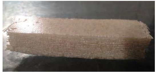
3. ábra. Réteges szerkezet kerámia gömbhéjakkal és üvegszövetrel erősítve
