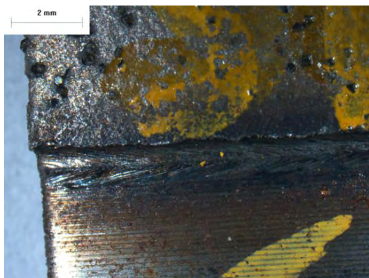
1. ábra. A lézerhegesztett varrat koronaoldali sztereomikroszkópos felvétele
