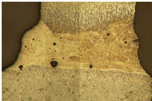
3. ábra. A varrat keresztmetszetének optikai mikroszkópos felvétele
