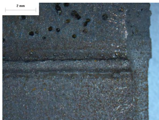
2. ábra. A lézerhegesztett varrat gyökoldali sztereomikroszkópos felvétele
