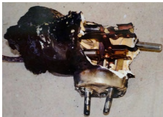
1. ábra. Kontaktkorrozó okozta károsodás villamos csatlakozónál
