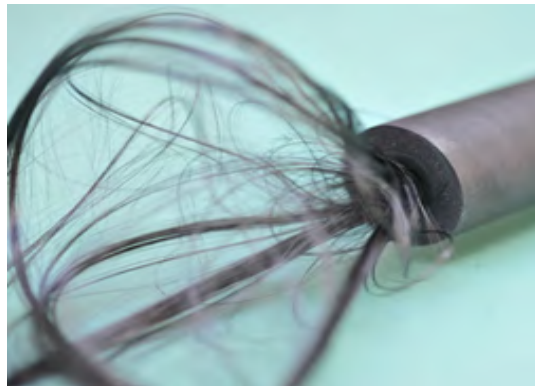
3. ábra. A szénszálköteg bolyhozódása a grafitból készült bemeneti kapu bejáratánál
